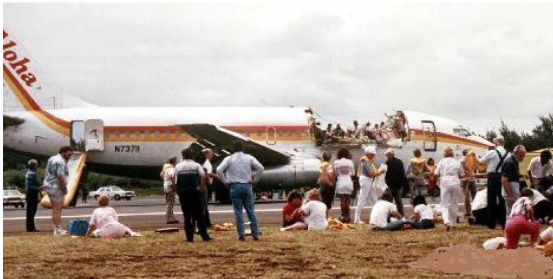
图 2-5-36 B737-200 飞机前机身上半部蒙皮撕裂
