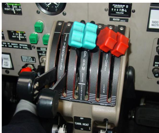
图 3-12-4 活塞发动机变距杆（PA44-180）
