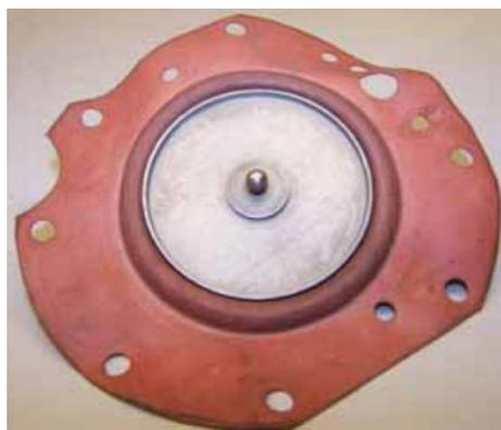
图 3-1-22 带球形活门的燃油薄膜
