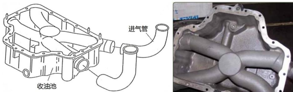
图 2-2-5 某发动机进气管从中穿过的收油池
