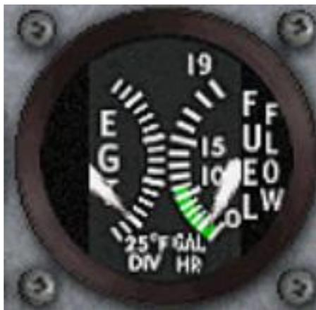
图 3-7-12 发动机排气温度表
