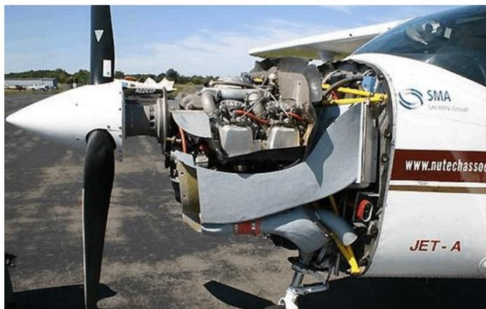
图 3-1-39 改装使用 SMA 公司的 SR305 发动机的塞斯纳 182 飞机
