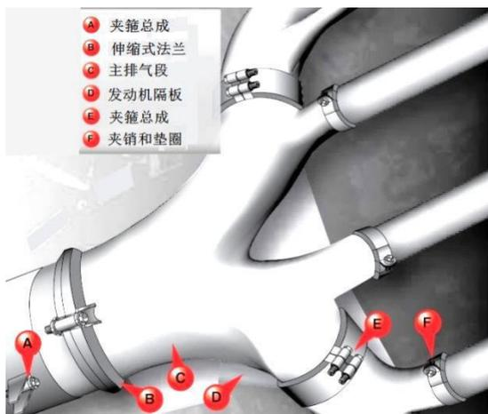
图 3-3-23 星型发动机上的排气集气环元件
