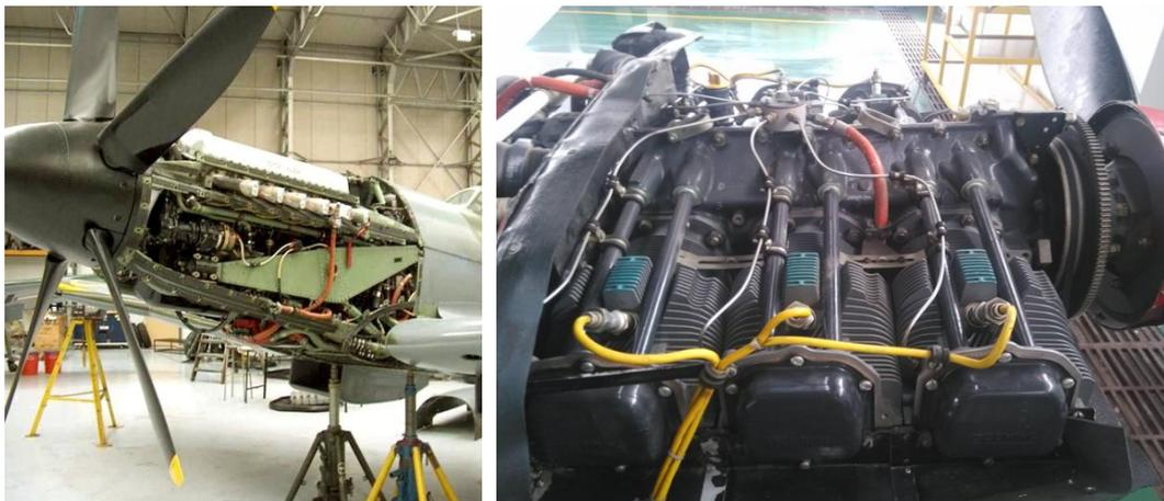
图3-4-1 液冷式发动机（左）和气冷式发动机（右）
