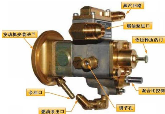
图 3-1-31 TCM 燃油泵管路接头
