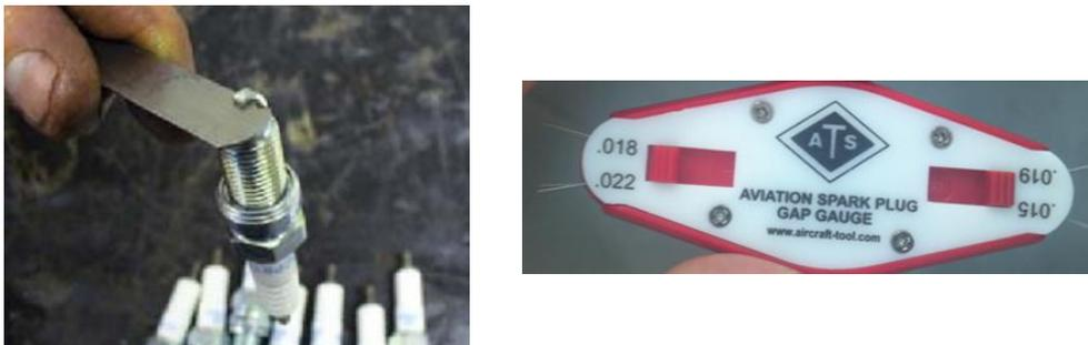
图 3-2-19 电嘴间隙调整及间隙测量工具（一种类型）
