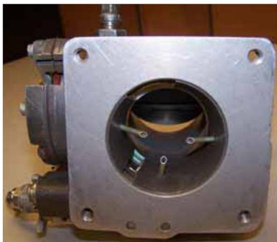
图 3-1-23 主燃油调节器的冲压空气管
