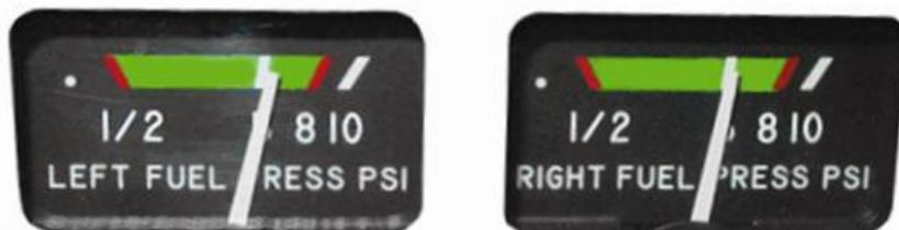
图 3-7-9 发动机燃油压力表
