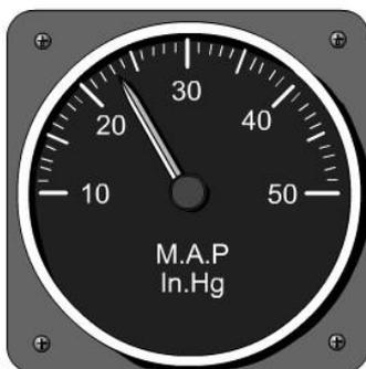
图 3-7-3 发动机进气压力表
