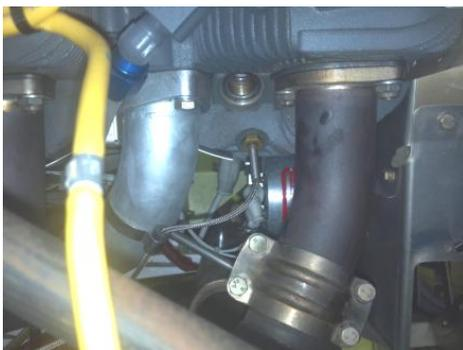
图 3-7-10 发动机 CHT 温度传感器
