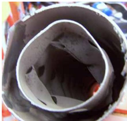
图 2-2-47 消音器内部故障
