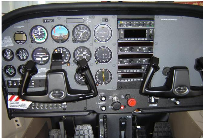
图 3-7-1 机械指针式指示系统
