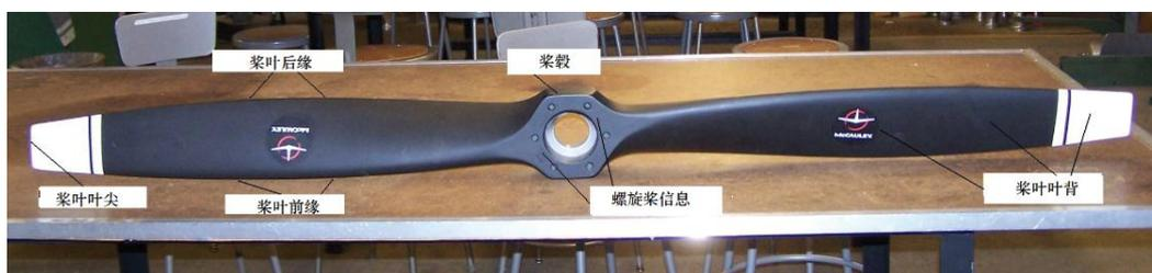
图 3-12-1 两叶定距螺旋桨
