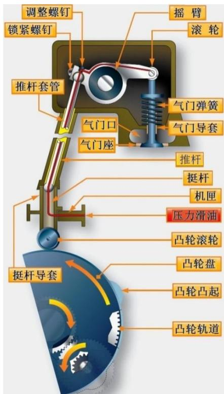
图 2-2-31 单排星型活塞发动机气门机构
