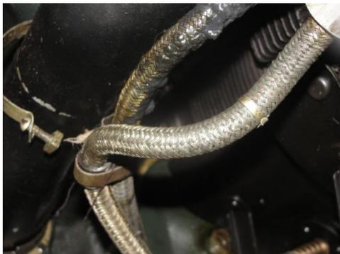
图 3-2-23 高压导线的隔波装置
