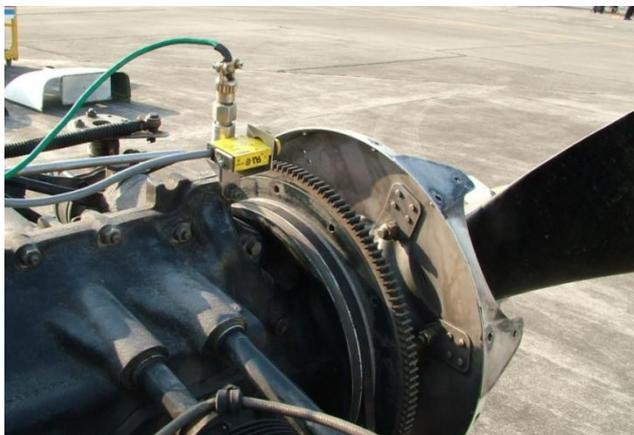
图 3-9-22 现场动平衡设备的安装
