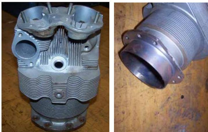
图 3-4-2 气冷式气缸
