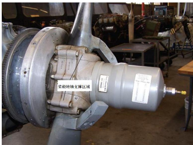
图 3-12-2 两叶变距螺旋桨桨毂
