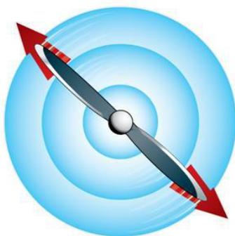
图 3-9-9 螺旋桨转动时的离心力
