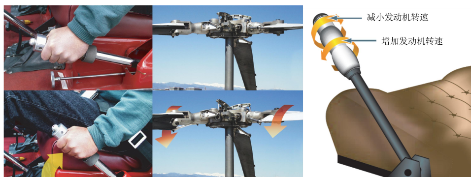
图 4-42 总距操纵实现直升机升降
