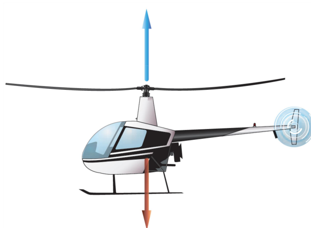
图 4-41 直升机垂直飞行时受力示意图
