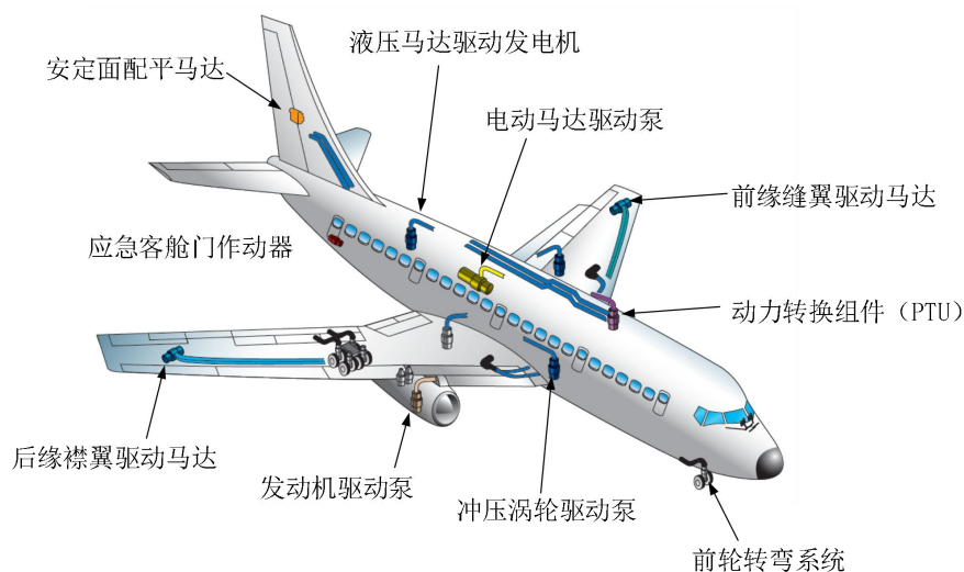
图 6-22 典型大型飞机液压系统
