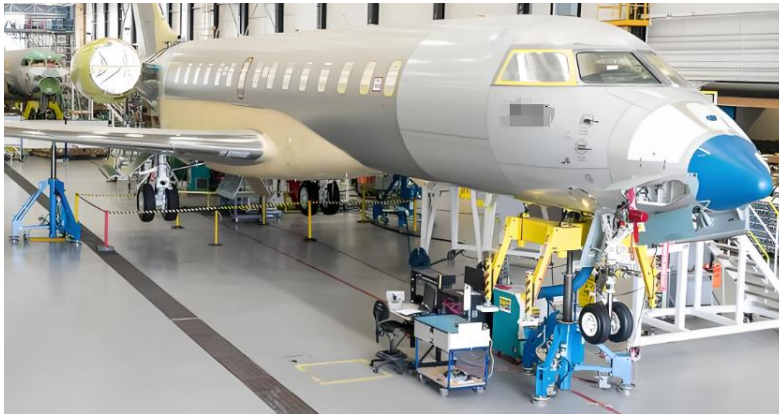
图4-7 飞机顶升千斤顶
