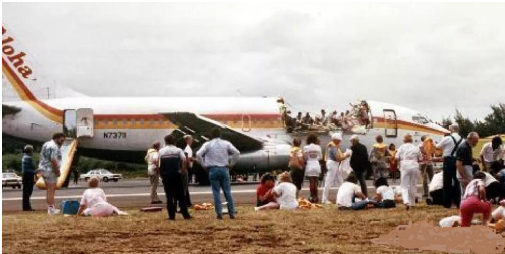
图 1-26 B737-200 飞机前机身上部蒙皮撕裂
