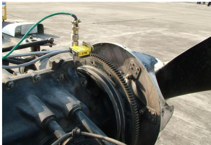
图 3-9-22 现场动平衡设备的安装
