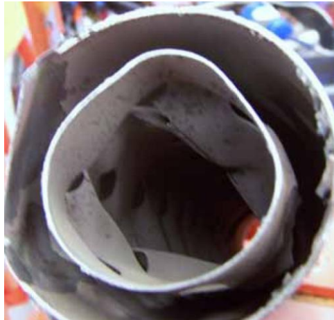
图 2-2-47 消音器内部故障
