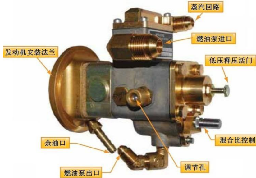
图 3-2-31 TCM 燃油泵管路接头
