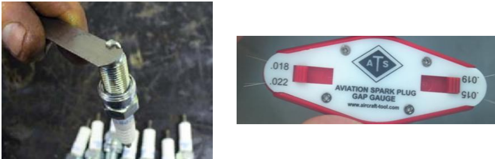
图 3-5-20 电嘴间隙调整及间隙测量工具（一种类型）
