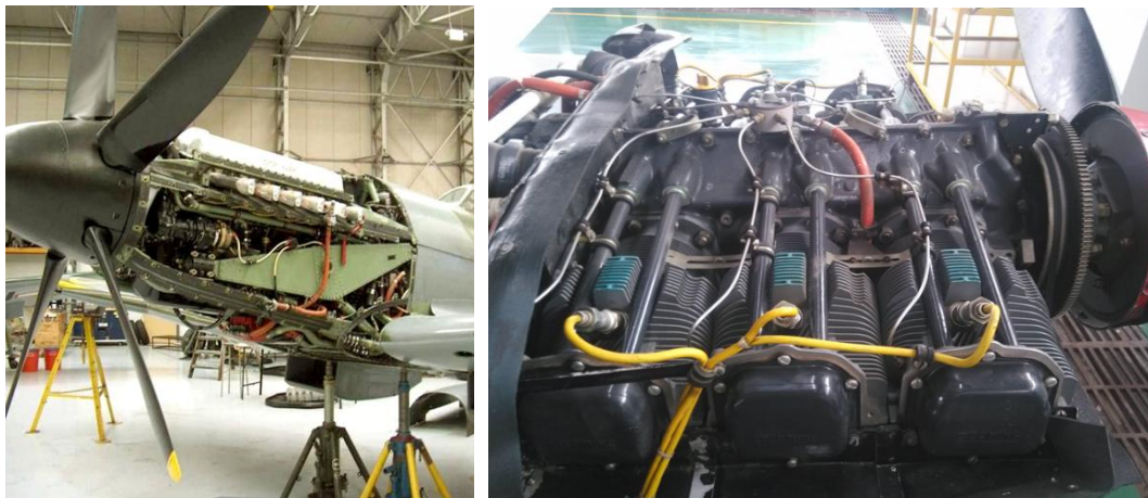
图 3-4-1 液冷式发动机（左）和气冷式发动机（右）
