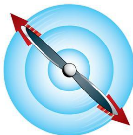
图 3-9-9 螺旋桨转动时的离心力
