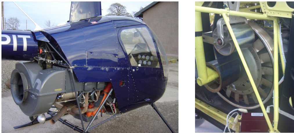
图 3-4-7 直升机活塞型发动机的冷却风扇（某两类机型）
