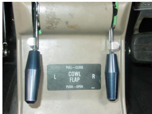
图 3-4-6 鱼鳞板操作手柄（某机型）
