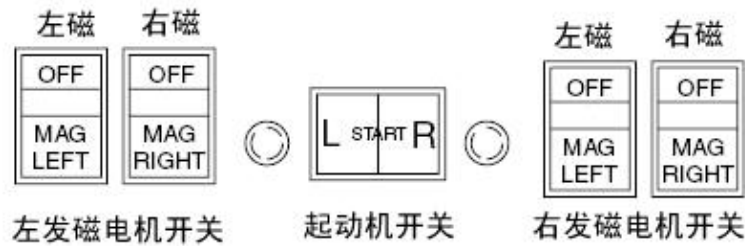
图 3-8-4 Piper PA-44-180 飞机磁电机和起动机开关示意图
