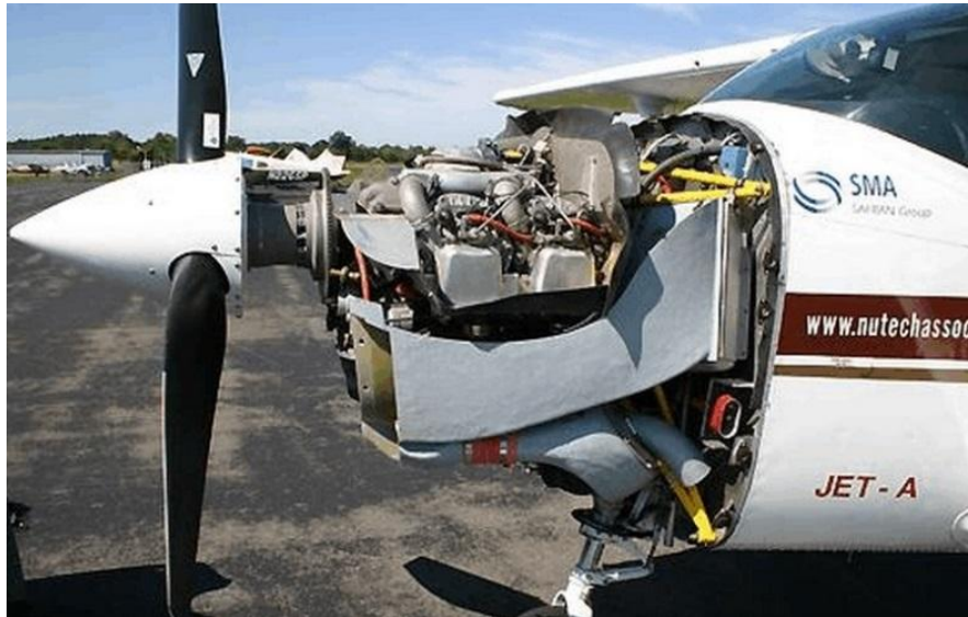
图 3-2-39 改装使用SMA 公司的SR305 发动机的塞斯纳 182 飞机
