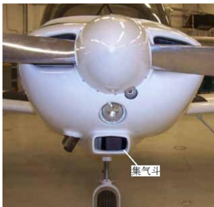
图 3-1-1 整流罩下方的集气斗
