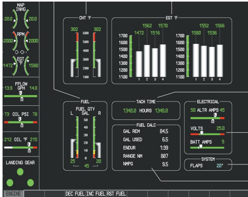
图 3-8-1 Paper PA-44-180 飞机发动机监控参数
