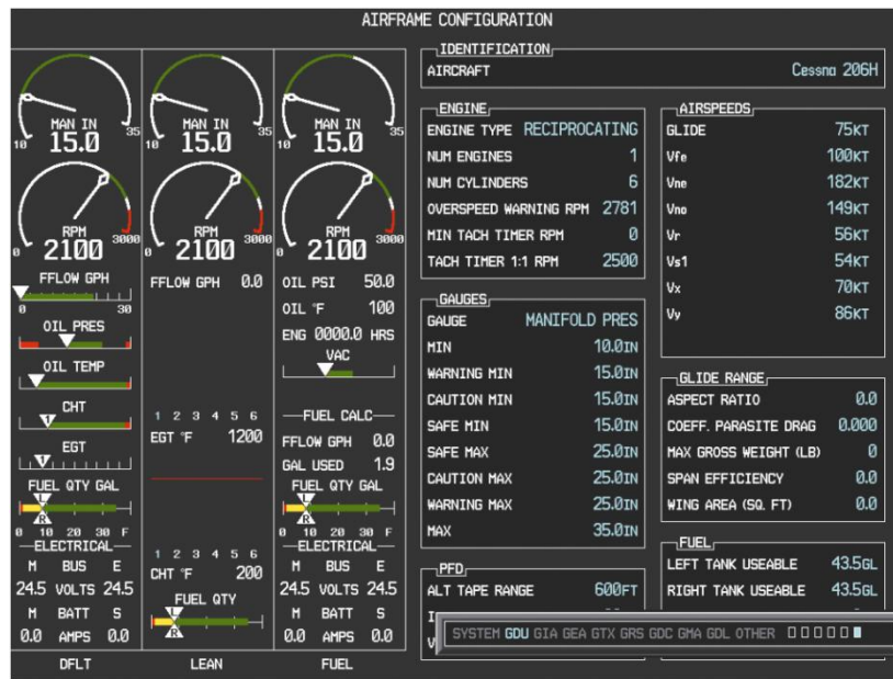
图 3-8-2 Cessna 206H 飞机发动机监控参数
