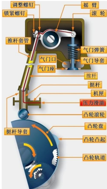
图 2-2-31 单排星型活塞发动机气门机构
