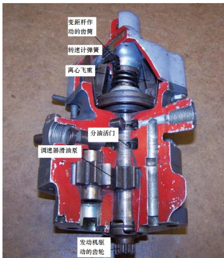
图 3-12-6 螺旋桨调速器（剖视图）
